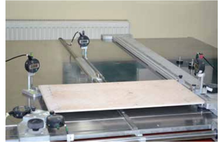
TS EN 10545 -2 Standardına göre boyut ve deformasyon kontrolü işlemi yapılıyor.
